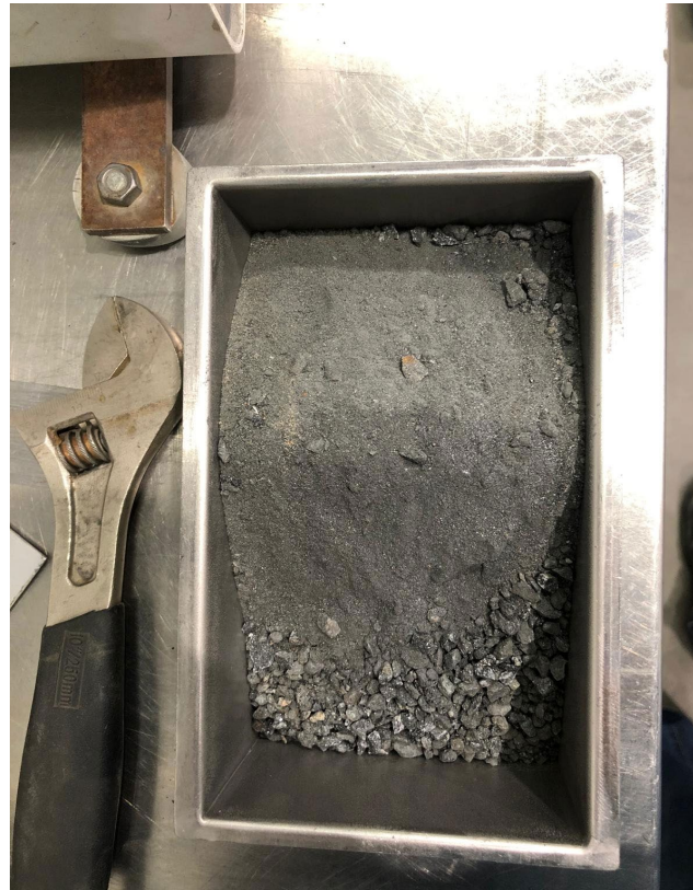
Fig. 6: Mini jaw crusher product ( <3.35\text{mm} )
